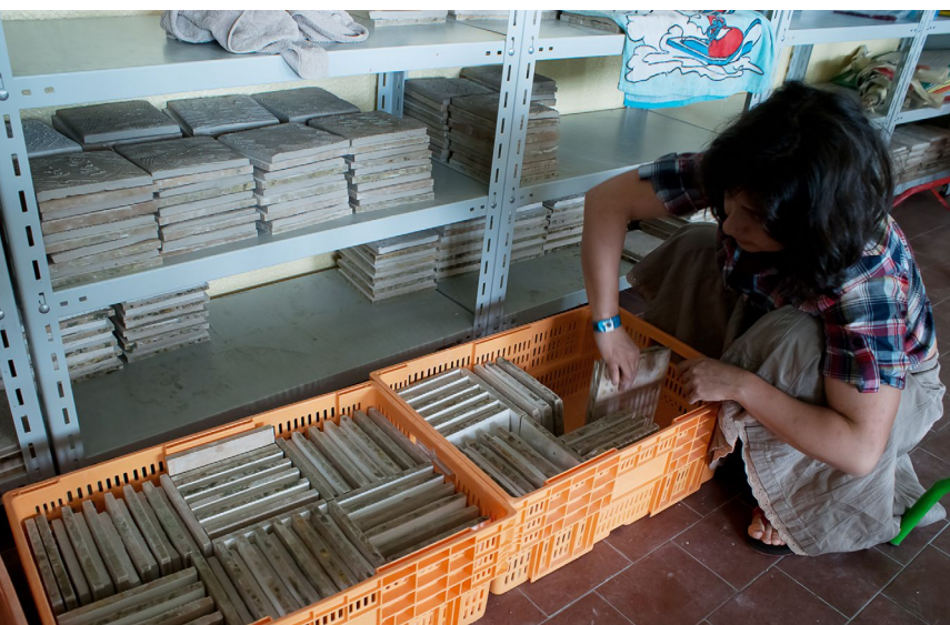
Fig. 35: Armazenamento dos azulejos realizados para secagem e transporte. Imagem: Bruno Mendes.
